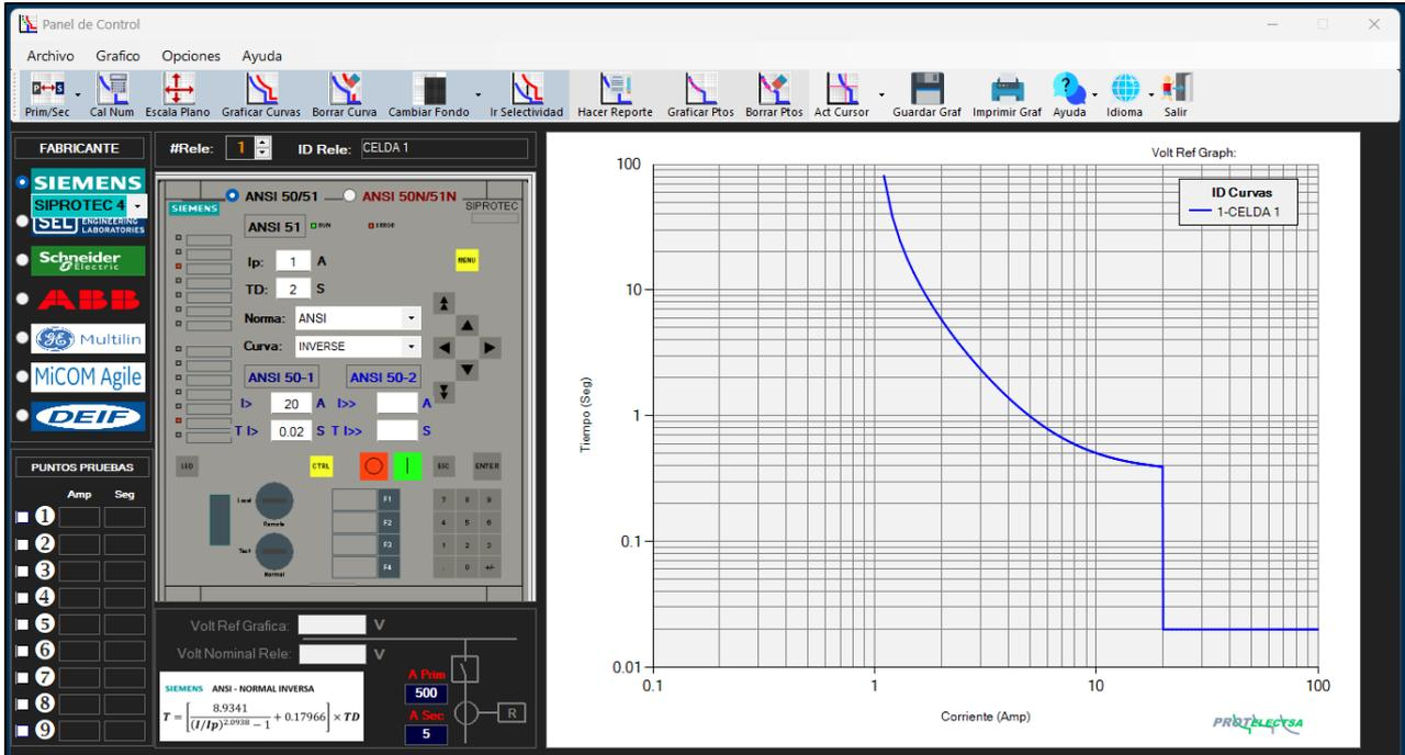
2.- En el módulo de **PUNTOS DE PRUEBAS**, se deben introducir los valores de los puntos de inyección de corriente, pero primero se debe seleccionar la cantidad de pruebas realizadas, en el ejemplo se inyectaron 5 puntos, se introducen los valores de inyección de corriente y los resultados del tiempo de disparo del relé de protecciones, luego se da click en **GraficarPuntos**
