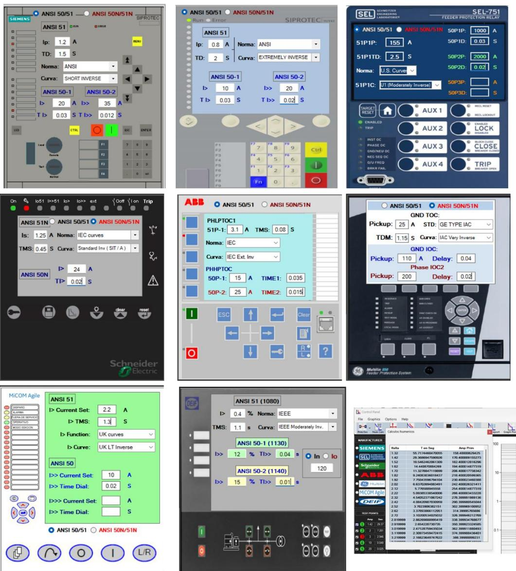
**4 Puntos de Pruebas:** En este menú se introducen, los valores de corrientes de fallas y tiempos de disparos, como por ejemplo los valores de inyección de corriente de una maleta de pruebas o el resultado de un evento registrado por el relé de protecciones.
