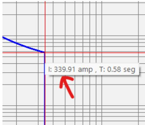
**Paso 8.-** Ya Con el valor de  $I_{maxF}$  (340 A, para este ejemplo), damos click el botón: **Calcular  $\Delta T$**  Luego se observa, el valor del **T1** en 0.58 Seg, para una  $I_{maxF}$  de 340 A @ 34.5 kV. del equipo
