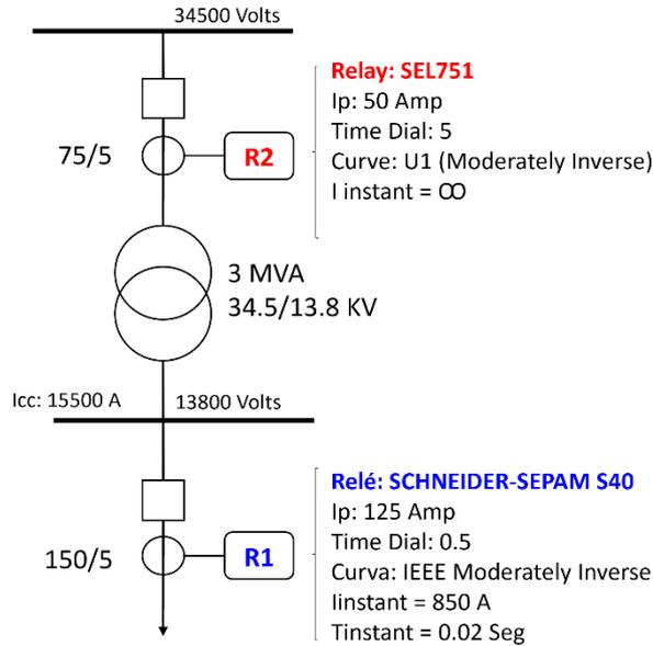
**Pasos 1 al Paso 5.-** Seleccionamos y graficamos la curva del Relé "Aguas Abajo" (#Relé:1) con sus ajustes, recordar no obviar el **Paso 4**, para este ejemplo el voltaje de Referencia es de 34500 Volts ya que es el voltaje mayor del sistema y el voltaje Nominal donde opera el Relé "Aguas Abajo" es de 13800 Volts
