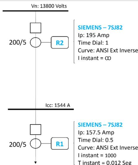
**Pasos 1 al Paso 5.-** Seleccionamos y graficamos la curva del Relé "Aguas Abajo" (#Relé:1) con sus ajustes, recordar no obviar el Paso 4, para este ejemplo el voltaje de Referencia y el voltaje Nominal es el mismo, según el diagrama unifilar.
