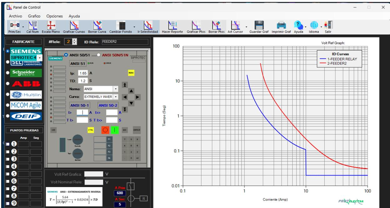
Aquí observamos que el valor de ajuste de la función ANSI 50 o Corriente Instantánea es infinito ( $\infty$ ), eso significa que los valores de **I>** y **TI>** lo dejamos en blanco, esto permite que la curva se prolongue y no tenga un punto de corte en corriente y tiempo.
