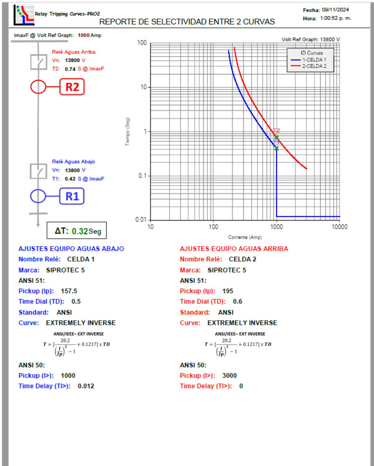
**Ejemplo #2:** Cálculo de selectividad entre dos curvas con diferentes niveles de tensión, según el siguiente diagrama unifilar
